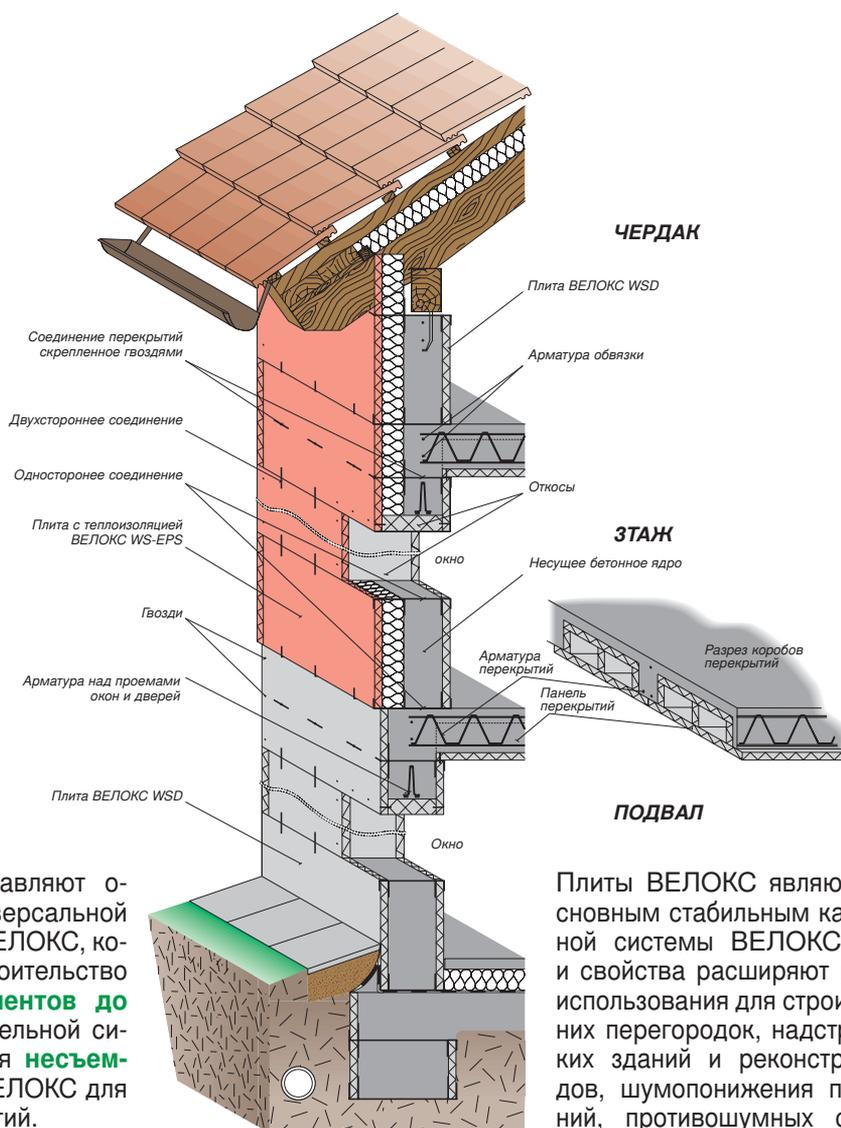
Плиты ВЕЛОКС представляют основной элемент универсальной строительной системы ВЕЛОКС, которая обеспечивает строительство комплексно **от фундаментов до крыши**. Основой строительной системы ВЕЛОКС является **несъемная опалубка** из плит ВЕЛОКС для несущих стен и перекрытий.
