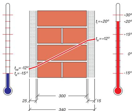
Точка росы (область конденсации) находится внутри кладки – повышается влажность а с тем и теплопроводность.
