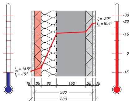
Температура точки росы ( $t_B = +11,5^\circ\text{C}$ ) находится в области пенополистирола, не повышает влажность бетонного ядра, а с ней связанную теплопроводность, т.е. тепловое сопротивление является одинаковым.
